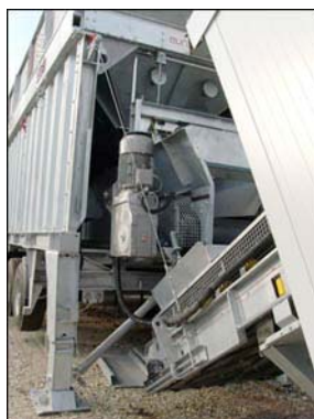
Bild 1: Bunkereinheit mit Förderbändern
