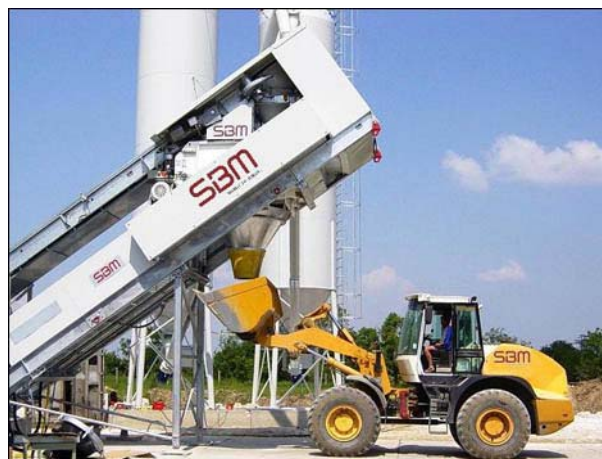
Bild 2: Betonentnahme bei der EUROMIX 1000/1600
