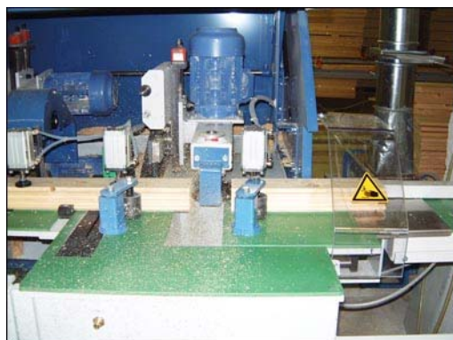
Bild 1: Stirnutfräse mit WAC 101L2 TH (3kW)
