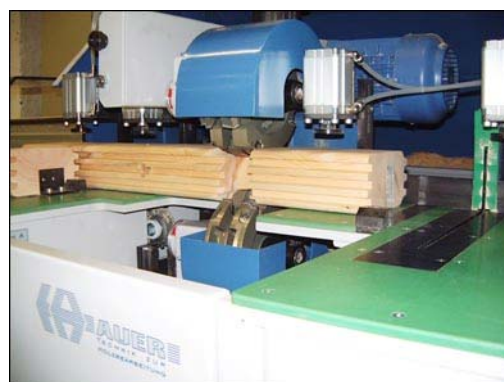
Bild 2: 4-fach Fräse mit Antriebsmotoren (3 bzw. 4kW)
